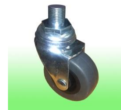
ล้อยางสีเทาหมุนรอบตัว ขนาด 7.5 ซม. (ล้อต่างประเทศ) หน้ายางกว้าง 3 ซม. กระทะล้อพลาสติกไม่เป็นสนิม จำนวน 4 ล้อ
